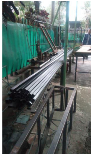
Gambar 8. Rangka Besi Kotak 2 x 2 cm
