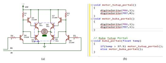
Gambar 7. (a) Penggerak motor portal, (b) Program buka tutup portal
