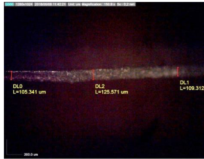
Gambar 14. Morfologi tebal geram setelah terpotong pada pahat no uji 10, hc 0.113 mm
