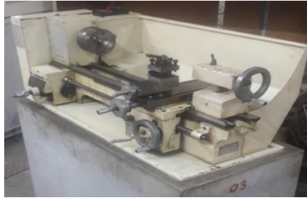
Gambar 5. Mesin bubut tipe CQ-6123
