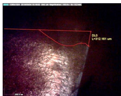
Gambar 13. Morfologi luasan area keausan tepi pada pahat no uji 10, V_B 0.303 mm 2
