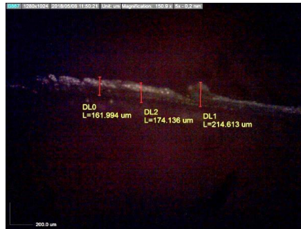
Gambar 15. Morfologi tebal geram setelah terpotong pada pahat no uji 11 hc 0.183 mm
