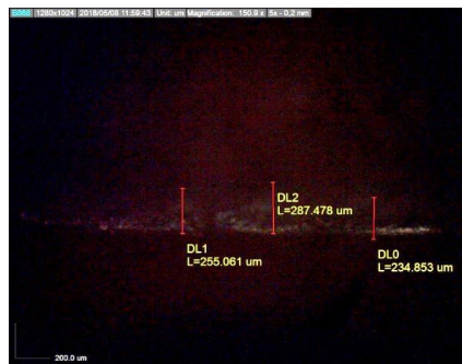
Gambar 16. Morfologi tebal geram setelah terpotong pada pahat no uji 12 hc 0.258 mm
