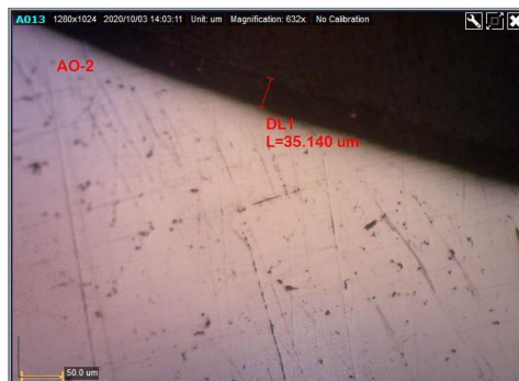
Gambar 4. Foto struktur mikro spesimen sprocket original depan
