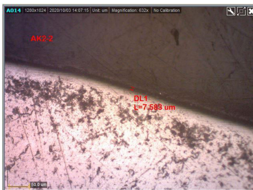
Gambar 6. Foto struktur mikro spesimen sprocket Kw 2 depan
