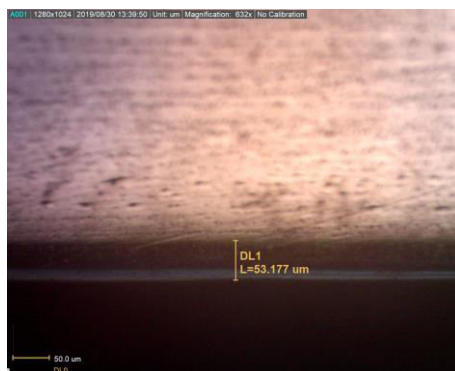
Gambar 7. Foto struktur mikro spesimen baja ST37
