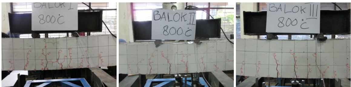
Gambar 13. Pola retak lentur pada ketiga benda uji balok beton bertulang suhu 800°C
