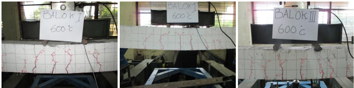
Gambar 12. Pola retak lentur pada ketiga benda uji balok beton bertulang suhu 600°C
