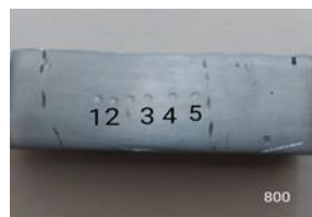
Gambar 4. Spesimen uji kekerasan putaran 800 rpm dengan suhu 800°C
