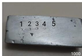
Gambar 2. Spesimen uji kekerasan putaran 800 rpm dengan suhu 1000°C
