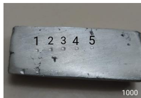
Gambar 2. Spesimen uji kekerasan putaran 800 rpm dengan suhu 1000°C
