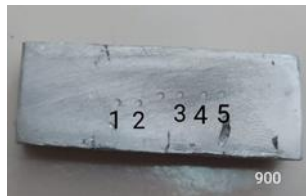
Gambar 3. Spesimen uji kekerasan putaran 800 rpm dengan suhu 900°C
