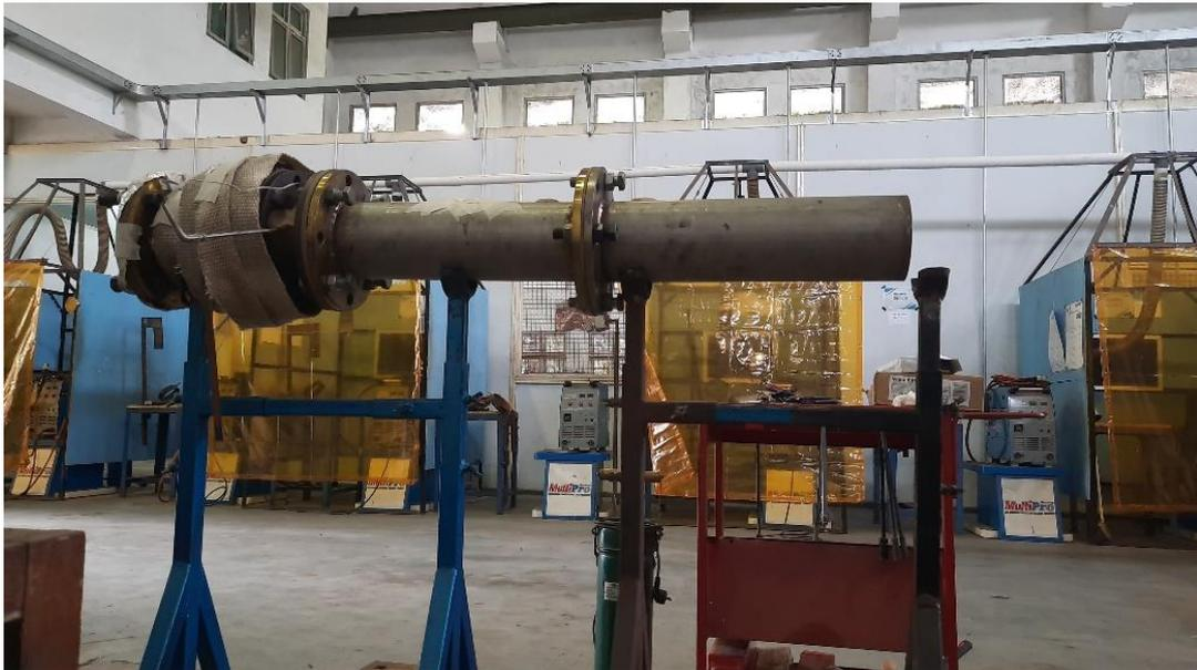
Gambar 2. Sistem termoakustik generator 108 mm
