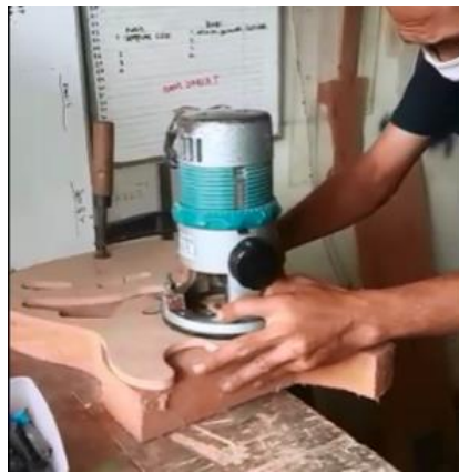
Gambar 1. Mesin router yang sudah ada
