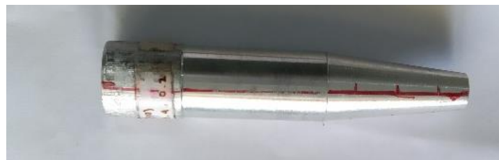
Gambar 4. Benda kerja bahan AA-6061 setelah proses bubut tirus
